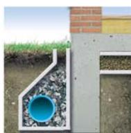
При строительстве фундаментов и подвальных стен геотекстиль Fibertex обеспечивает чистоту и эффективность дренажной системы, защищая здание от сырости.
