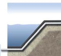
Геотекстиль Fibertex защищают водонепроницаемую мембрану от разрывов.
