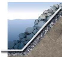
Геотекстиль Fibertex защищают береговую полосу, так как благодаря их гибкости и водонепроницаемости воздействие волн и течений не вызывает эрозии и размывания самого берега.
