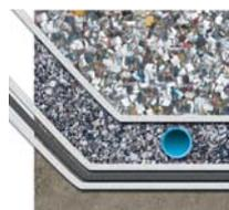
Как указано выше, геотекстиль Fibertex с обеих сторон защищают мембраны от разрывов, а также способствуют обнаружению протечек.
