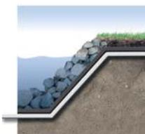
Водонепроницаемая мембрана защищена от разрывов при помощи геотекстиля Fibertex.
