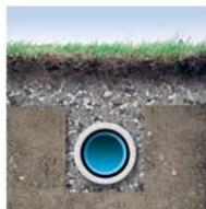
Укладка водонепроницаемого геотекстиля Fibertex вокруг дренажной трубы обеспечивает эффективность и долговечность дренажа, защищённого от засорения.
