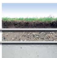
В конструкции крыш подземных сооружений геотекстиль Fibertex используются в качестве разделительного слоя и механической защиты мембран крыши, а также как фильтрозащита для любого дренажного слоя.
