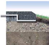
Геотекстиль Fibertex обеспечивают разделение и стабильность между основанием и верхними компонентами дороги.
