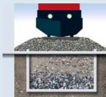
Вследствие увеличения массы и скорости движения железнодорожных составов, несущие слои железных дорог подвергаются все более существенным нагрузкам. Геотекстиль Fibertex стабилизирует основание, благодаря чему оно может выдерживать динамические нагрузки.
