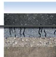
Пропитанная битумом ткань Fibertex AM-2 выравнивает напряжения от трещин и швов в старой поверхности покрытия и препятствует их повторному образованию на композитном верхнем слое Densiphalt.
