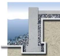
Уложенные под причальной стенкой геотекстиль Fibertex защищают дренажный слой, снимая часть водяного давления на стенку. Если геотекстиль Fibertex уложены перед причальной стенкой, они защищают морское дно от размывания.
