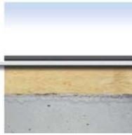
В конструкции крыш геотекстиль Fibertex используется в качестве опорного слоя, механической защиты мембран крыши, а также как защитный фильтр дренажного слоя.
