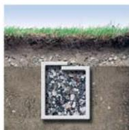
Геотекстиль Fibertex обеспечивают защиту дренажной системы от вымывания мелкозернистого материала.
