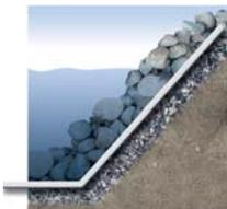
Геотекстиль Fibertex защищают береговую полосу, так как благодаря их гибкости и водонепроницаемости воздействие волн и течений не вызывает эрозии и размывания самого берега.
