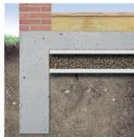
Уложенные под почвенным настилом водонепроницаемые геотекстиль Fibertex защищают дренажный слой от загрязнения со стороны бетона и основания.
