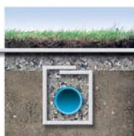
При устройстве поверхностного дренажа существует риск его засорения частицами земли. Геотекстиль Fibertex препятствует проникновению мелкозернистого материала в дренажный слой и тем самым обеспечивает эффективность дренажной системы.
