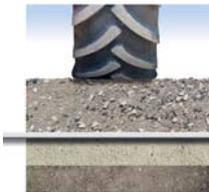
Геотекстиль Fibertex, уложенный под слоем гравия, повышает несущую способность дороги, которая, таким образом, сможет выдерживать постоянную тяжёлую нагрузку транспорта. Поэтому автомобили, тракторы и другие транспортные средства не завязнут в слое гравия.
