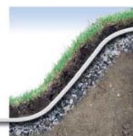
Благодаря слою геотекстиль Fibertex, уложенному под верхним слоем склона, обеспечивается его защита от разрушения почвенными, дождевыми и талыми водами, которые вымывают мелкозернистый материал.
