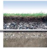
При помощи геотекстиль Fibertex стабилизируются травяные, гравийные, земляные и земляные спортивные покрытия. Они обеспечивают эффективный дренаж, тем самым сохраняя ровную поверхность покрытия.
