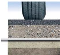
Твёрдые, статично нагруженные поверхности требуют стабильной основы. Геотекстиль Fibertex Geotekstiler разделяет слои из различных материалов, обеспечивая, тем самым, самую высокую несущую способность.
