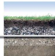
При помощи геотекстиль Fibertex стабилизируются травяные, гравийные и земляные спортивные покрытия. Они обеспечивают эффективный дренаж, тем самым сохраняя ровную поверхность покрытия.
