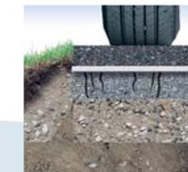
Благодаря битумной пропитке Fibertex AM-2 не даёт воде проникать вниз, в несущие слои, тем самым защищая содержащиеся в них мелкозернистые материалы от вымывания. Это снижает риск появления трещин и выбоин в поверхности.
