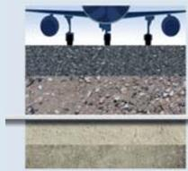
В конструкции, покрытие которых испытывает сильные нагрузки, геотекстиль Fibertex стабилизирует несущие слои, благодаря чему они противостоят динамическим нагрузкам.
