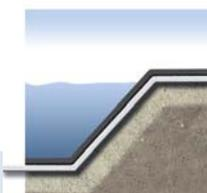
Геотекстиль Fibertex защищают водонепроницаемую мембрану от разрывов.
