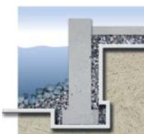
Уложенные под причальной стенкой геотекстиль Fibertex защищают дренажный слой, снимая часть водяного давления на стенку. Если геотекстиль Fibertex уложены перед причальной стенкой, они защищают морское дно от размывания.
