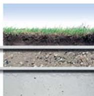
В конструкции крыш подземных сооружений геотекстиль Fibertex используются в качестве разделительного слоя и механической защиты мембран крыши, а также как фильтрозащита для любого дренажного слоя.
