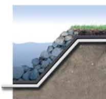
Водонепроницаемая мембрана защищена от разрывов при помощи геотекстиля Fibertex.
