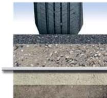
Путём разделения различных слоёв материала геотекстиль Fibertex стабилизирует дорожные конструкции, подверженные динамическим и статическим нагрузкам
