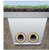
При размещении геотекстиль Fibertex на дне траншеи обеспечивается стабильное и устойчивое основание.
